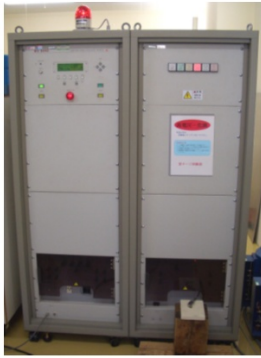
雷サージ印加試験機 [雷サージ発生装置]
