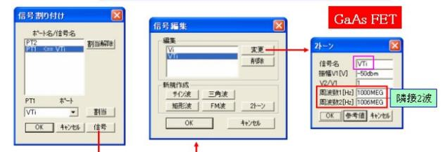
すように入力ポート PT1 について、隣接 2 波 [トランジスタ・アンプでは  $\Delta f = f_2 - f_1 = 6\text{MHz}$  (映像信号を想定) として、 $f_1 = 800\text{MHz} / f_2 = 806\text{MHz}$ 、GaAs FET アンプでは  $f_1 = 1000\text{MHz} / f_2 = 1006\text{MHz}$ ] を割り付ける。同様に振幅は  $-50\text{dBm}$  に仮設定するが、HB 解析ではこれに限定されずに最適範囲をスイープ [可変] する。
